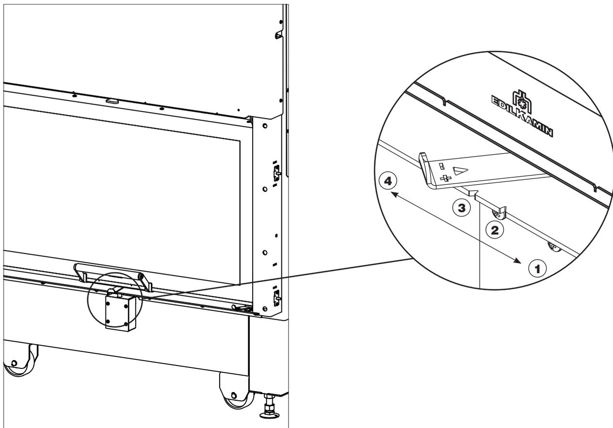
In funzione del tiraggio, in fase di accensione soprattutto, c'è la possibilità di favorire il tiraggio con la leva di tiraggio.
