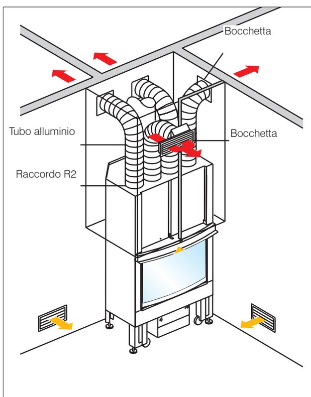
**Kit canalizzazione aria in versione forzata (con Kit Air Diffuser)**
